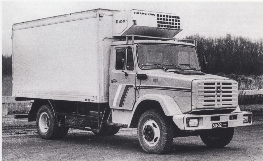
Рефрижератор ОдаЗ-47093, доведенный до соответствия правилам ЕЭК ООН и проходивший испытания на Дмитровском автополигоне
