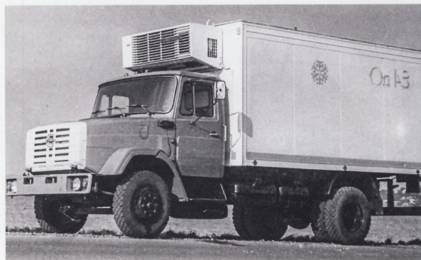
Опытный образец ОдА3-4709 с импортным холодильным агрегатом Euro-Cool
