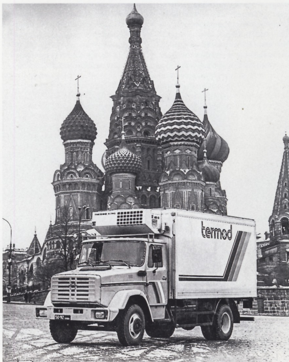
Одесский рефрижератор на шасси ЗИЛ-4331 предполагалось использовать в качестве тягача для прицепа-рефрижератора ОДАЗ-87053
