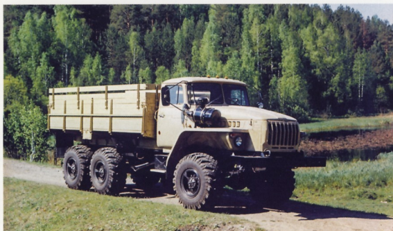
Грузовой «Урал-43202-0611-31» с дизельным двигателем ЯМЗ
