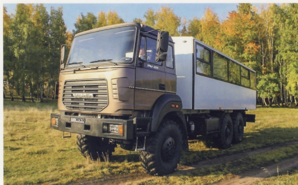
Вахтовый автобус «Урал-3255» на шасси «Урал-4320» с бескапотной кабиной
