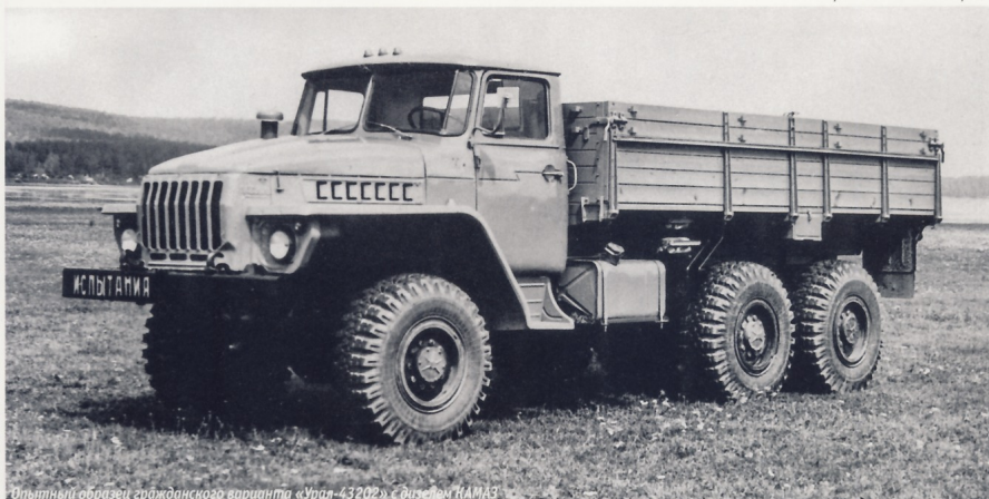
Опытный образец гражданского варианта «Урал-43202» с дизелем ЯМЗ-236
