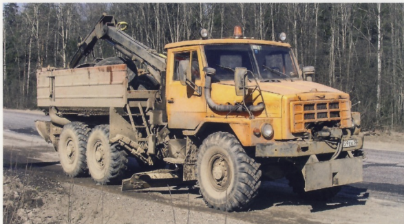
Коммунальная дорожная машина на шасси «Урал-55224-10» с дизелем Deutz и унифицированной с КАМАЗами кабиной (1995 год)
