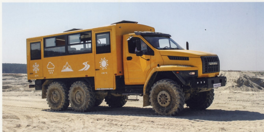
Вахтовый автобус «Урал-3255» на шасси «Урал-4320» с капотной кабиной «NEXT»
