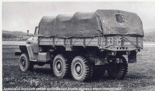
Армейский вариант имеет надставные борты из дерева и текстильные чехлы
