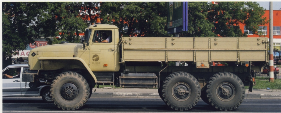
Под установку дизельных двигателей ЯМЗ-238 автомобиль «Урал-43202-0611-31» оснастили удлиненным капотом
