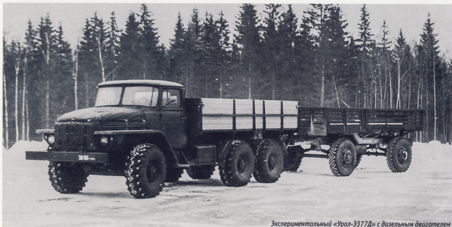
Экспериментальный «Урал-3377Д» с дизельным двигателем
