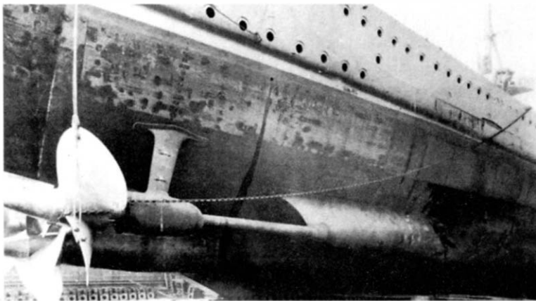
Пробитая в кормовой части «Шарнхорста» от взрыва торпеды, выпущенной эсминцем «Акаста»
