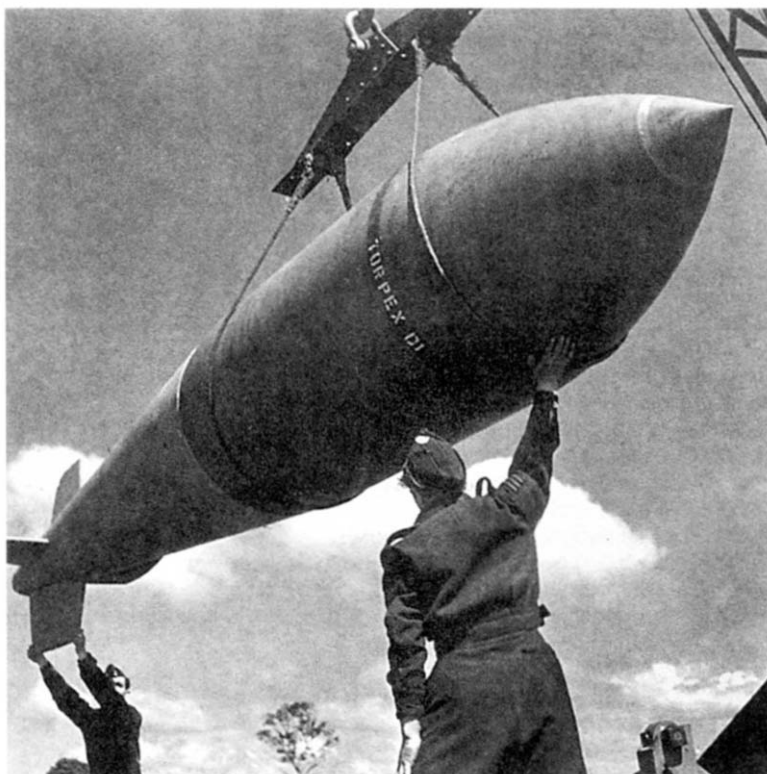
Британская сверхтяжелая бомба «Толлбой» весом 12 000 фунтов (5443 кг) — смертельное оружие для любого линкора
