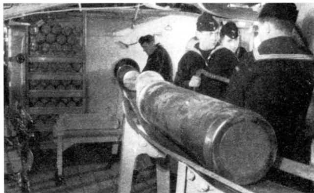
Подача картузов из зарядного погреба (справа) и их погрузка на лоток 28-см орудия в башне линкора «Гнейзенау» (слева)
