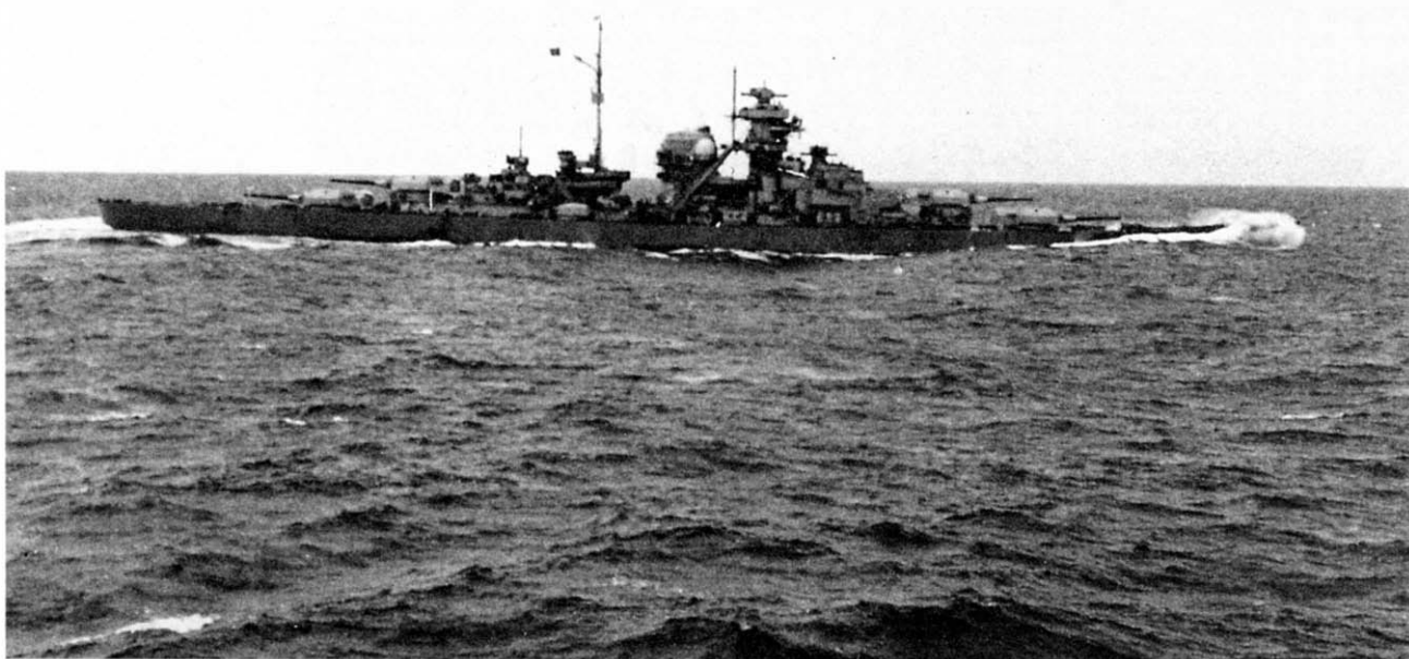
Один из последних снимков «Бисмарка», сделанный утром 24 мая 1941 г. с борта «Принца Ойгена». Заметен дифферент на нос — следствие попадание снаряда с «Принс оф Уэльса»
