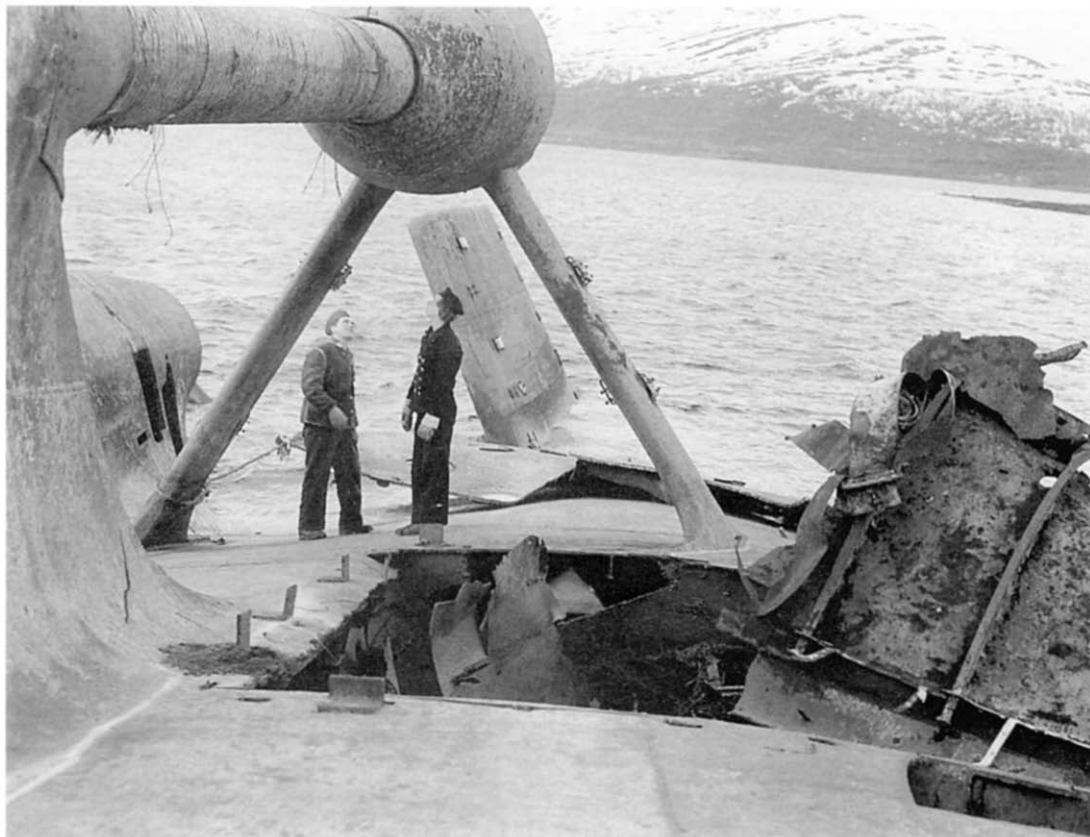
Перевернувшийся «Тирпиц», вид на кронштейн правого гребного винта
