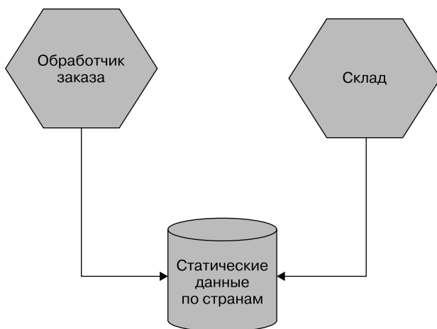
Рис. 2.7. Несколько сервисов, получающих доступ к общим статическим справочным данным
