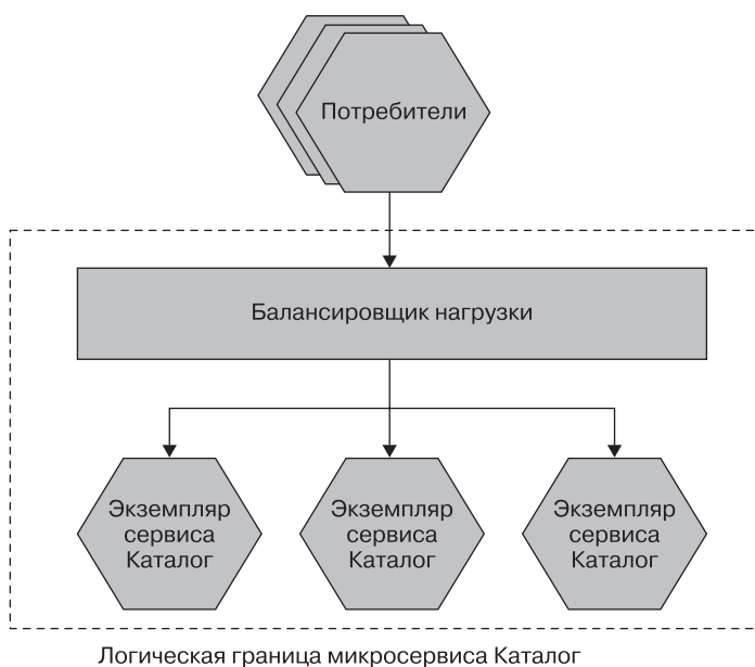
Рис. 13.1. Микросервис Каталог развернут в виде нескольких экземпляров с балансировщиком нагрузки для распределения запросов
