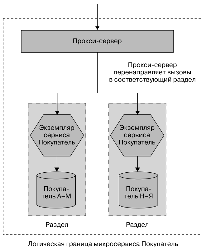
Рис. 13.5. Запросы направляются в соответствующий экземпляр микросервиса
