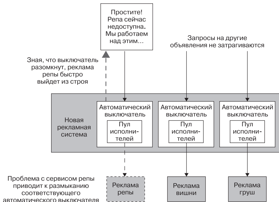
Рис. 12.6. Добавление автоматических выключателей в AdvertCorp
