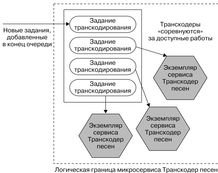
Рис. 13.2. Транскодирование для стриминговой передачи расширяется с использованием шаблона конкурирующих потребителей
