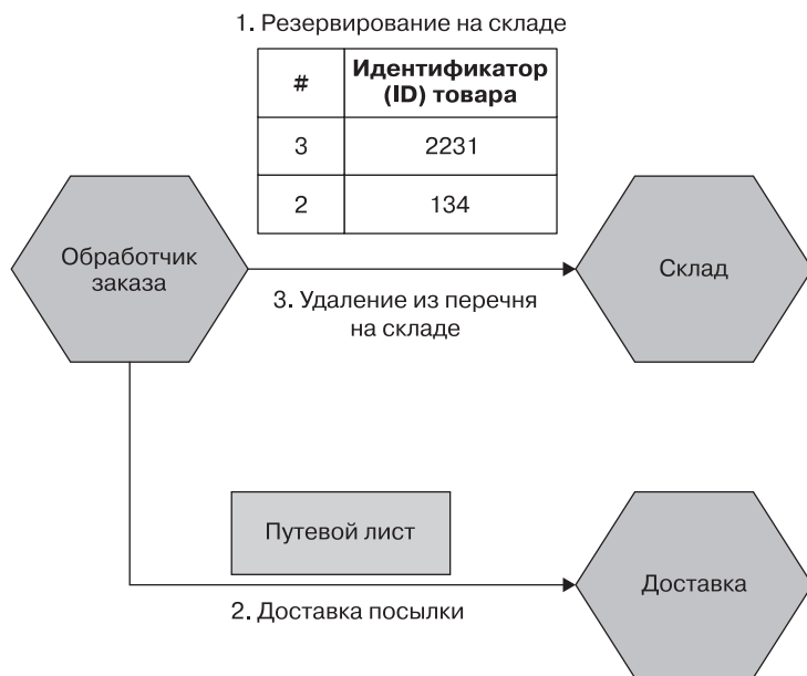
Рис. 2.5. Один из способов обойти сквозную связь заключается в непосредственном взаимодействии с нижестоящим сервисом
