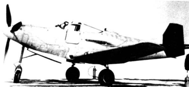
Второй XP-39E с угловатыми контурами вертикального оперения и прямыми законцовками крыла
