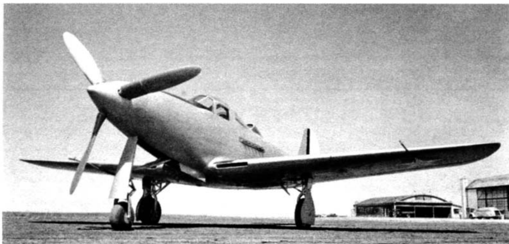
XP-39B весной 1940 г. Размеры всасывающего патрубка двигателя увеличены, изменены щитки носовой стойки шасси
