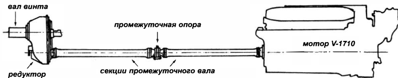
Схема мотоустановки «Аэрокобры»
