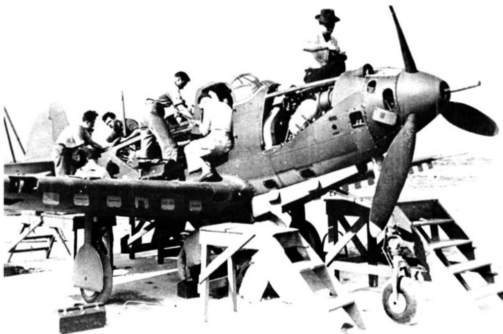
Сборка P-39D-1 на полевом аэродроме
