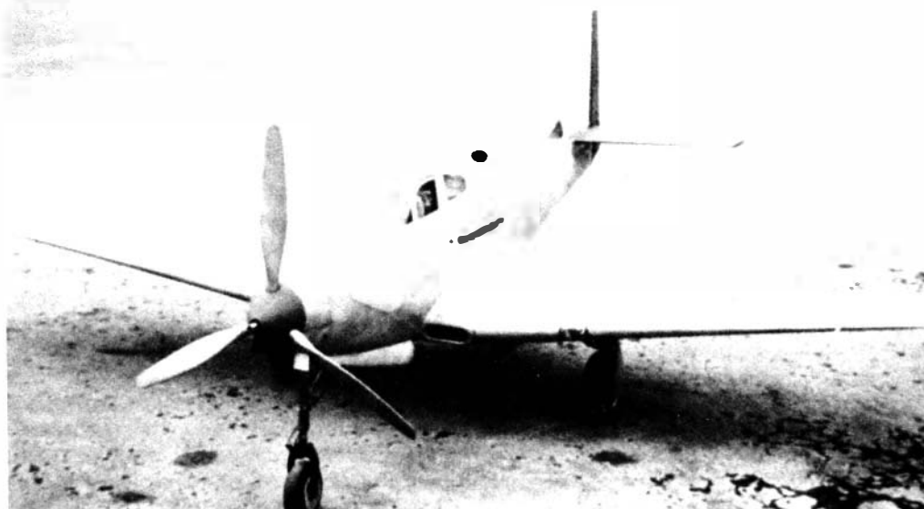
Второй XP-39E с угловатыми контурами вертикального оперения и прямыми законцовками крыла
